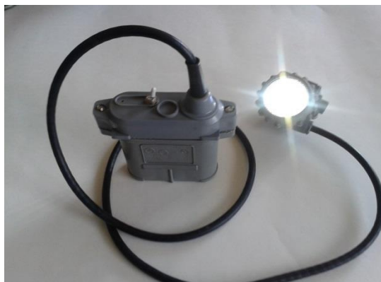
Радиомаяк, встроенный в аккумуляторный блок шахтного головного светильника
